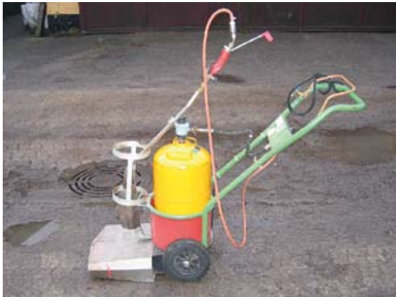
Lille kærrebrænder. Benytter luftformig gas
