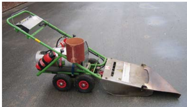
Større kærrebrænder. Benytter flydende gas
