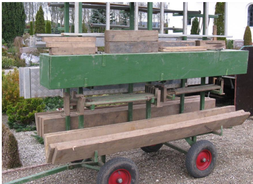
Materialevogn med afstivningsmateriale
